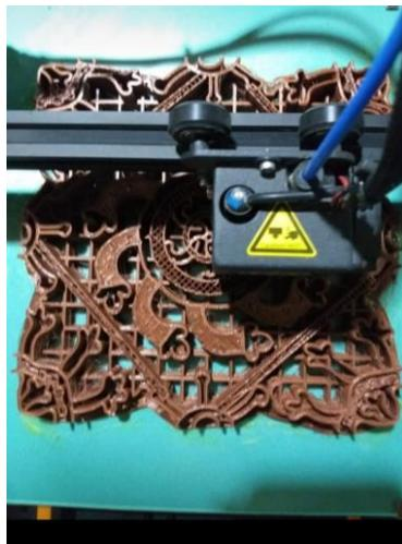
**Figure 1** Proses Pembuatan Cap Batik Bahan PLA dengan Mesin 3D ANET
